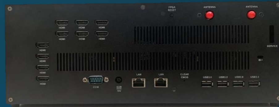
GeniBox-Pro 9/12+1 後視圖,可支援FHD@60~120Hz x9 或12 4x3 或 3x3 電視牆拼接
