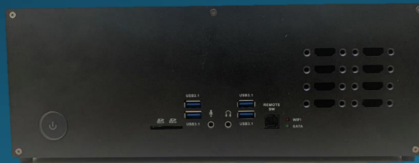
GeniBox-Pro 前視圖,可支援FHDx8 或4Kx4 通道影像採集
